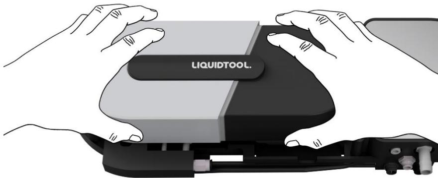
Fig. 14: Posizionare il sensore 01 nell'extender
