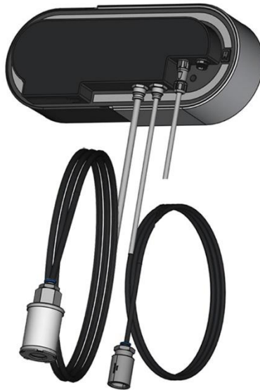
Fig. 14 : conduites de raccordement raccordées
