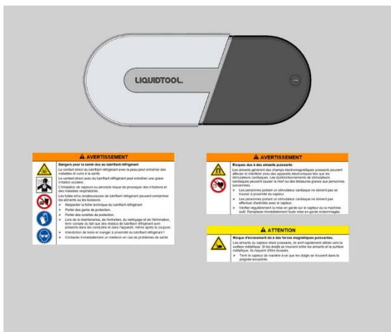
Fig. 16 : mise en place des mises en garde (exemple)
