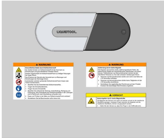
Abb. 4: Sicherheitshinweise an der Werkzeugmaschine (Beispiel)
