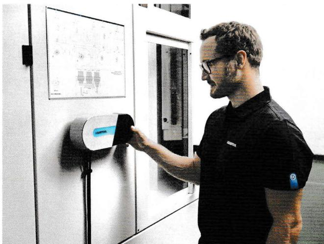
Bild 1: Der LIQUIDTOOL Coolant Manager ist eine intelligente, IIoT-basierte Lösung zur Überwachung von Kühlschmierstoffen
